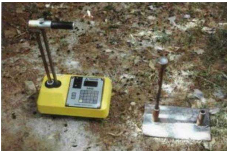
Συσκευή ελέγχου πυκνότητας με πυρηνική μέθοδο
